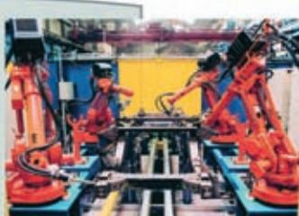
Робототехнические комплексы для дуговой сварки
