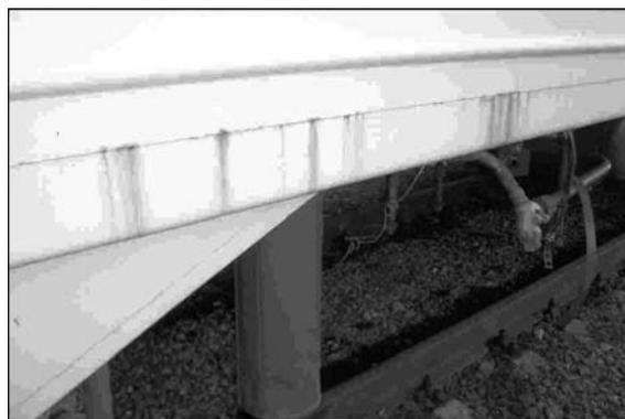
Рис. 2. Вид вагона с дефектами сварного шва, возникшими в процессе его эксплуатации
