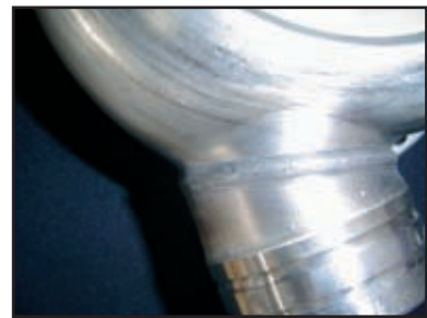
Фланец трубы из нержавеющей стали 1.4301, сваренный с помощью процесса Puls-Mix ( v_{св} = 60 см/мин)
