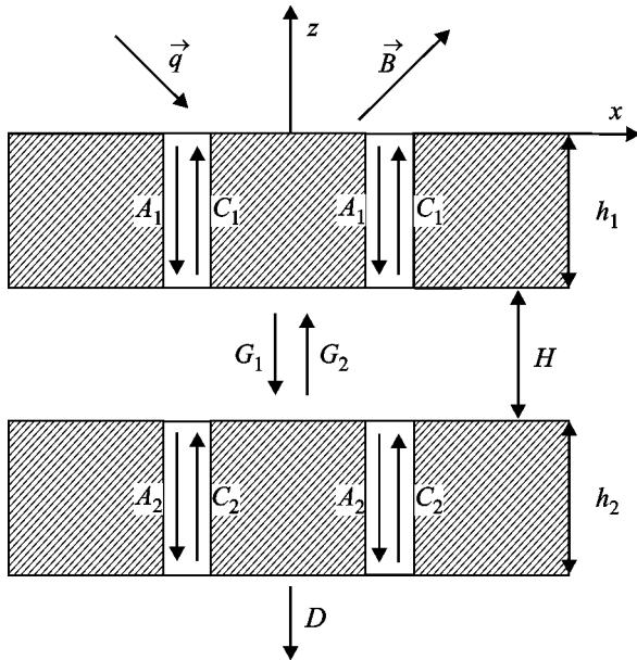
Рис. 3. Поперечное сечение базовой ячейки двойного экрана
