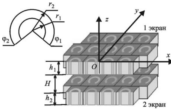
Рис. 1. Двойной экран конечной толщины с коаксиально-секторными отверстиями
