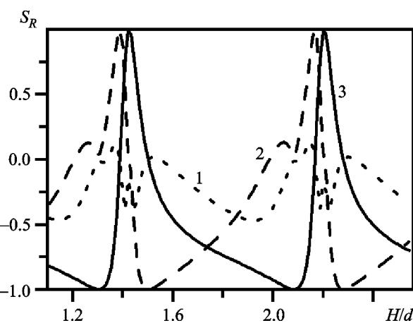
**Рис. 8.** Зависимости параметров Стокса отраженной волны от относительного расстояния между экранами: кривая 1 –  $S_1$ ; кривая 2 –  $S_2$ ; кривая 3 –  $S_3$
