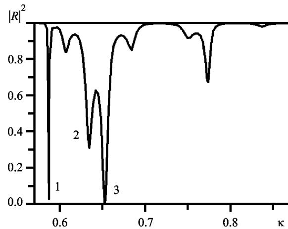
Рис. 5. Зависимость квадрата модуля коэффициента отражения от частотного параметра
