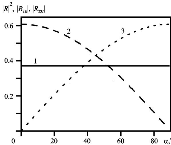
**Рис. 6.** Зависимости квадрата модуля коэффициента отражения (линия 1) и модулей коэффициентов отражения  $TE$ - и  $TM$ -волн (линия 2 и линия 3 соответственно) от угла поляризации падающей волны
