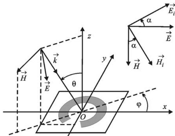
Рис. 2. Пространственная ориентация векторов электромагнитного поля в падающей волне. Показан случай падения  $TE$ -волны
