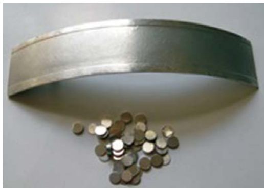
Стрічка, прокатана з відходів алюмінієвих сплавів (розробка ІПМ НАН України)
