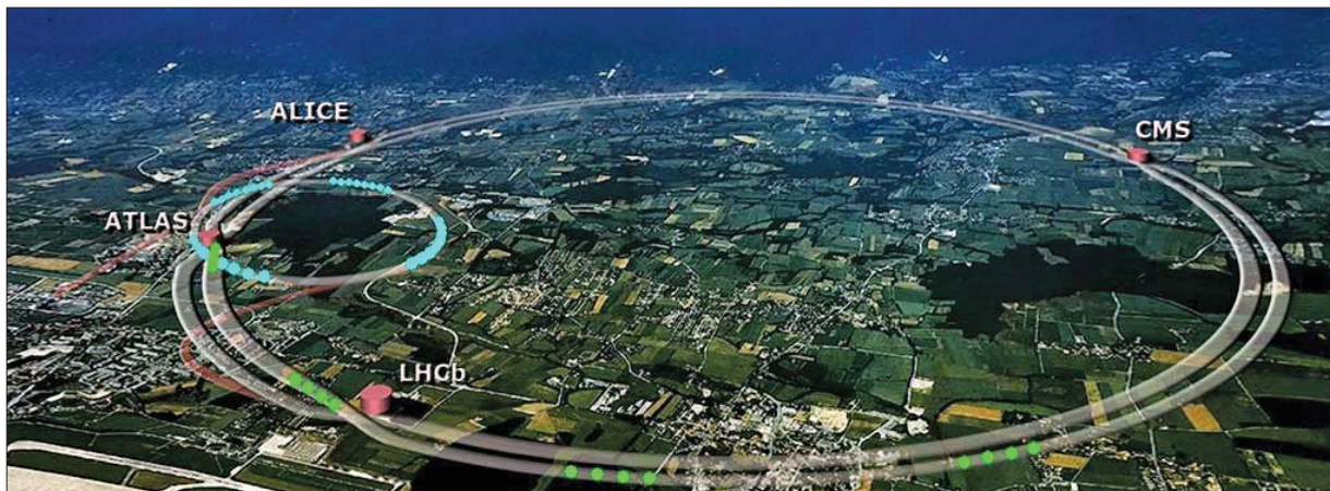
Великий адронний колайдер у ЦЕРН — найпотужніший прискорювач елементарних частинок, розташований на глибині 100 м, з довжиною кільця 27 км, до складу якого входять 4 основні детектори — ALICE, ATLAS, CMS, LHCb — та 3 допоміжні — TOTEM, LHCf, MoEDAL
