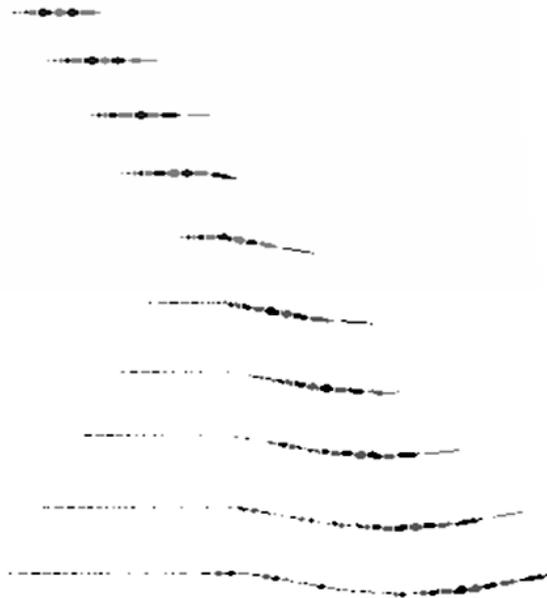
Рис. 3. Последовательные стадии распространения  $SH$  волн в плоскости, перпендикулярной плоскости залегания угольного пласта через каждые 10 мс, начиная с момента 30 мс от начала возбуждения колебаний
