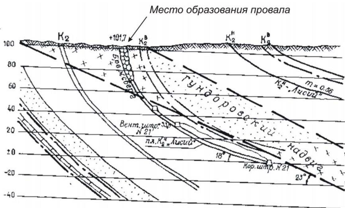
Рис. 3. Провал на устье бремсберга закрытой шах. № 54 в г. Донецке Ростовской области
