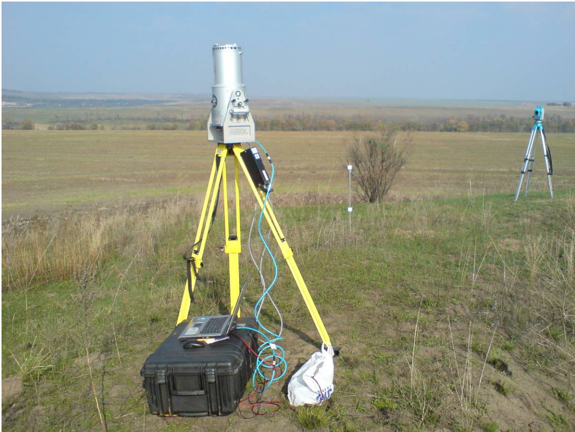
Рис. 3. Лазерна скануюча система Riegl LMS Z 420i
