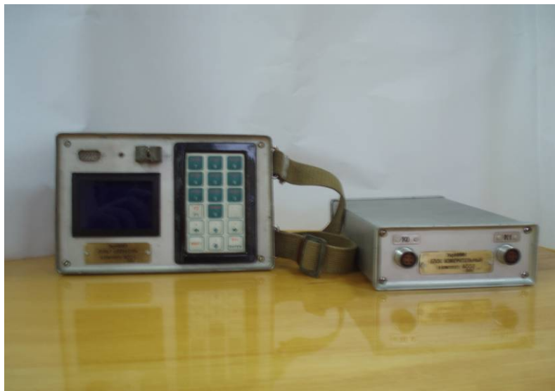
Рис. 2. Апаратура спектральної сейсмозв'язки АСС-2
