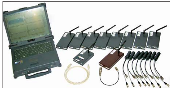
Рис. 3. Загальний вигляд блоків макета 8-канальної радіотелеметричної системи акустико-емісійного моніторингу стану об'єктів тривалого експлуатування [17]
