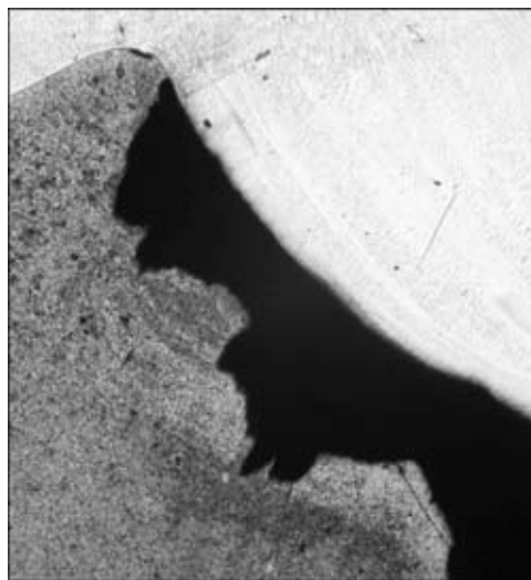
Рис. 1. Микроструктура коррозионного повреждения металла ЗТВ сварного соединения стали 20 и 08X18H10T (X25)
