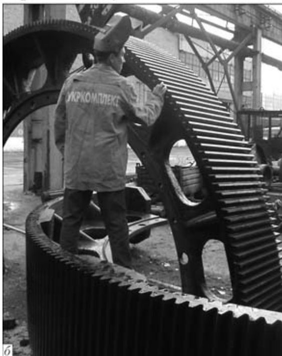
Рис. 4. Схема восстановления двух секторов зубчатого венца шаровой мельницы (а) и внешний вид восстановленных секторов (б): 1 — профиль изношенного зуба; 2, 3 — профиль наплавленного зуба соответственно после механической обработки и наплавки
