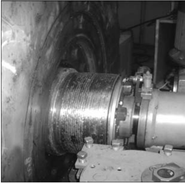
Рис. 6. Наплавленный вал привода эскалатора метрополитена
