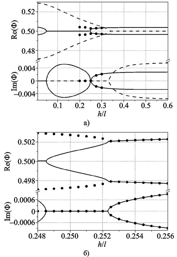
**Рис. 4.** Зависимость постоянной распространения от глубины канавок решетки: а) – при различных частотах  $\kappa=0.471$  (штриховая кривая),  $\kappa=0.496$  (сплошная кривая),  $\kappa=0.496$  (кружочки) и б) –увеличенный фрагмент при  $\kappa=0.496$  ( $d/l=0.5$ )
