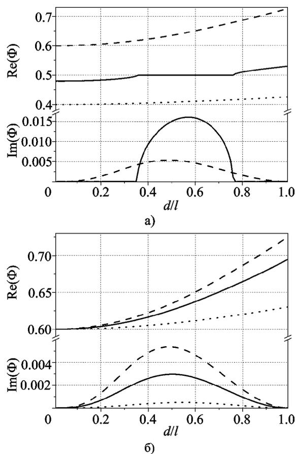
**Рис. 3.** Зависимости реальной и мнимой частей постоянной распространения от ширины канавок: а) –  $h/l = 0.37$ ;  $\kappa = 0.6$  (штриховая кривая),  $\kappa = 0.48$  (сплошная кривая),  $\kappa = 0.4$  (пунктирная кривая) и б) –  $\kappa = 0.6$ ;  $h/l = 0.37$  (штриховая кривая),  $h/l = 0.17$  (сплошная кривая),  $h/l = 0.07$  (пунктирная кривая)
