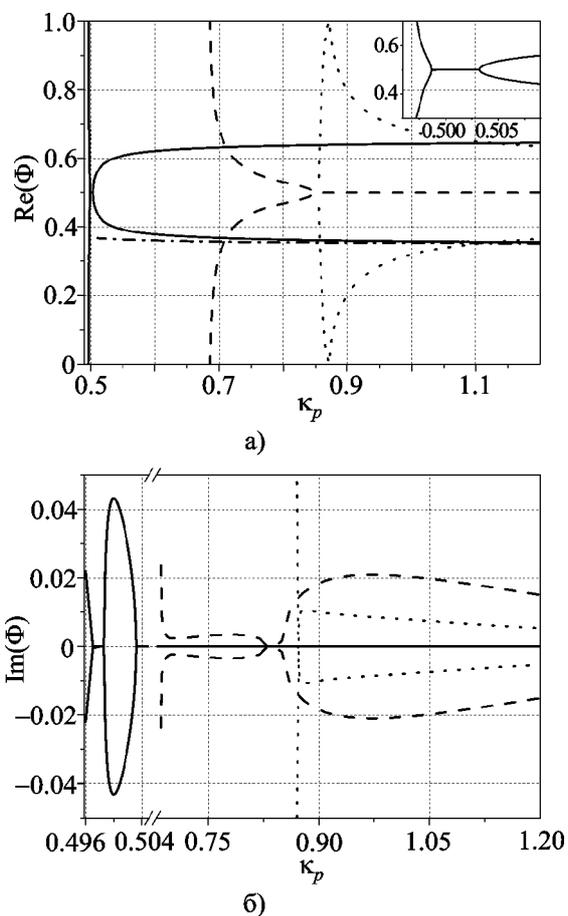
**Рис. 5.** Зависимость реальной (а) и мнимой (б) частей постоянных распространения от относительной плазменной частоты при различных частотах ( $d/l = 0.5$ ,  $h/l = 0.37$ ):  $\kappa = 0.35$  (сплошная кривая),  $\kappa = 0.48$  (штриховая кривая),  $\kappa = 0.6$  (пунктирная кривая)
