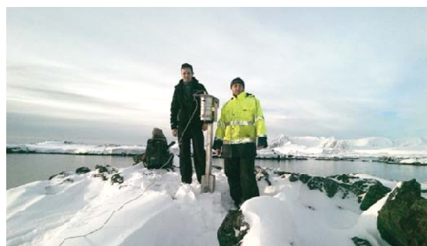
В. Демидов та Д. Литвинов устанавлюють індикатор-приставку для досліджень атмосферної електрики на базі антарктичної станції
