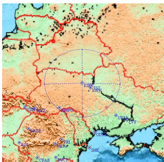
Рис. 1. Результат обработки сейсмического события 14.01.2011 г. (05:04), зарегистрированного станцией “Киев-IRIS” ( \varphi = 47,545 ; \lambda = 33,764 )
