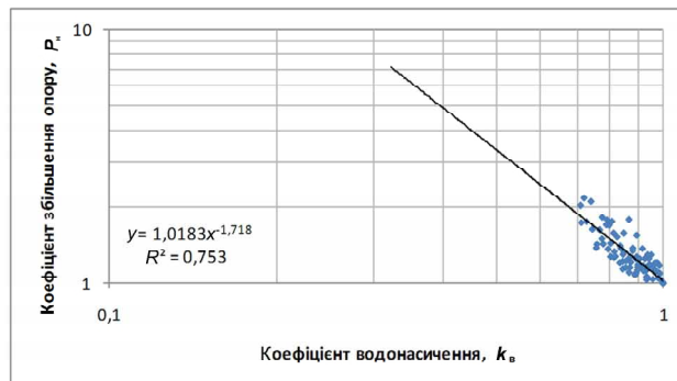
Рис. 3. Кореляційна залежність між коефіцієнтом водонасиченості ( k_b ) і коефіцієнтом збільшення опору ( P_n ) для пісковиків (а), алевролітів (б) і вапняків (в)
