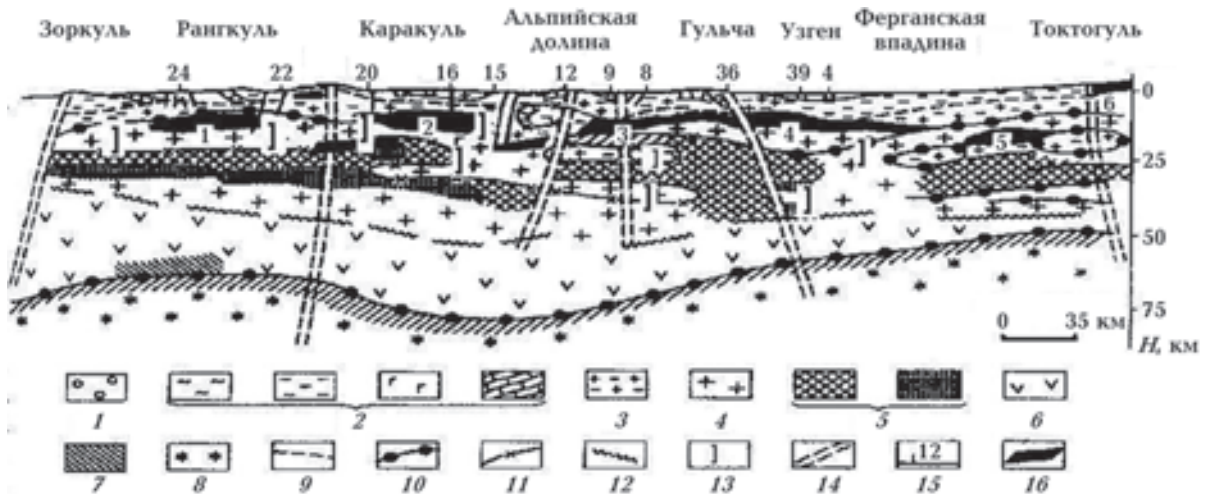
Рис. 7. Сейсмоэлектрический разрез по профилю Зоркуль—Токтогуль [Земная ..., 1984]: 1 и 2 — осадочно-метаморфогенные и вулканогенные породы мезозоя—докембрия с V_p=4\div5 км/с; 3 — сланцы с V_p=5,5\div5,9 км/с; 4 — гранитоиды с V_p=6\div6,3 км/с; 5 — гнейсы с V_p=6,4\div6,7 км/с; 6—7 — амфиболиты, гранулиты, эколгитизированные породы с V_p=6,9\div7,2 км/с; 8 — периодиты; 9 и 10 — границы фундамента и Мохо, 11—12 — сейсмические границы в коре; 13 — границы волновода [Краснопевцева, Шевченко, 1998]; 14 — разломы; 15 — точки МТЗ; 16 — коровые проводники (1 — Юго-Восточного Памира с S>2000 См, 2 — Северного Памира с S>2000 См, 3 — Восточно-Алайской зоны с S=500\div1000 См, 4 — Южного Тянь-Шаня с S>5000 См, 5 — Восточно-Ферганской зоны с S=3000 См, 6 — Северного Тянь-Шаня с S>5000 См).
