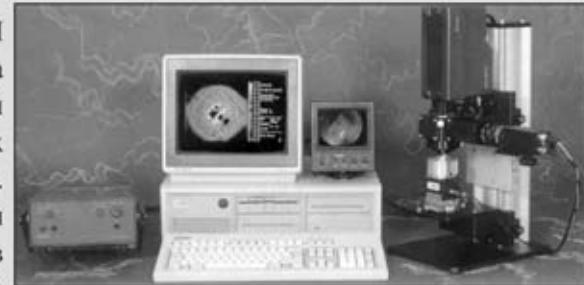
Наличие нескольких сменных объективов и ИК-микроскоп позволяет настраивать систему на различные режимы измерений макро- и микрообъектов в диапазоне температур от 20 °C до 1500 °C с пространственным разрешением < 20 мкм и времененным разрешением < 20 мкс при погрешности измерений < 2 %. Температурное разрешение не хуже 0,07 °C при 300 К. Предусмотрена также возможность измерения мощности тепловых потоков в режиме инфракрасного видения.
