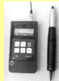
Индикатор вибродиагностический 77Д11 — прибор для контроля технического состояния подшипников качения методом ударных импульсов.
