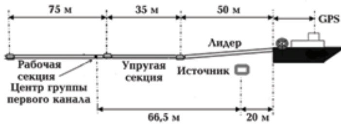
Рис. 9. Методическая схема размещения забортного оборудования сейсмического комплекса.
