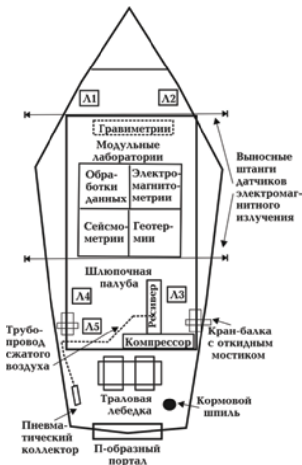
Рис. 1. Расположение судовых силовых механизмов (Л1—Л5 — спускоподъемные лебедки) и модульных геофизических лабораторий на НИС "Профессор Водяницкий".
