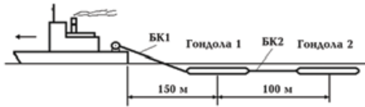
Рис. 6. Забортная часть магнитометра-градиентометра МРМГ-03 "IMPEDANCE" и схема буксирования гондол.
