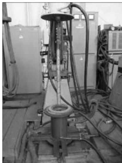
Рис. 5. Камерная электрошлаковая печь на базе аппарата А-550
