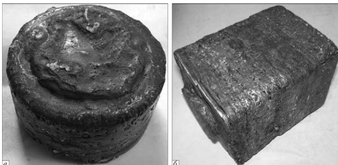
Рис. 4. Слитки круглого (а) и квадратного (б) сечений, полученные в результате ПДП
