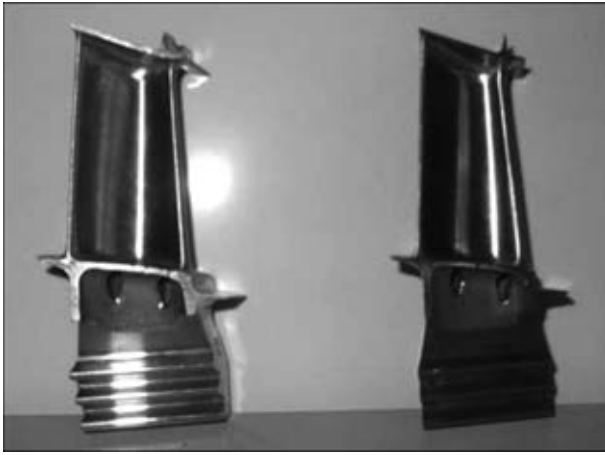
Рис. 6. Внешний вид рабочих лопаток ГТД с многослойным жаростойким покрытием \text{MeCrAlY/Al}_2\text{O}_3
