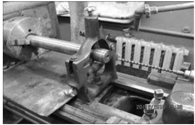
Рис. 5. Изготовление длинномерного катода из сплава NiCrAlY
