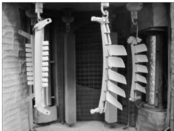
Рис. 9. Лопатки различных ступеней компрессора вертолетного двигателя после осаждения на них семислойного защитного эрозионно-стойкого покрытия 7Co/7TiN
