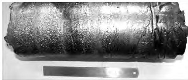
Рис. 3. Слиток \gamma -TiAl, полученный при плазменно-дуговом переплаве прессованной заготовки
