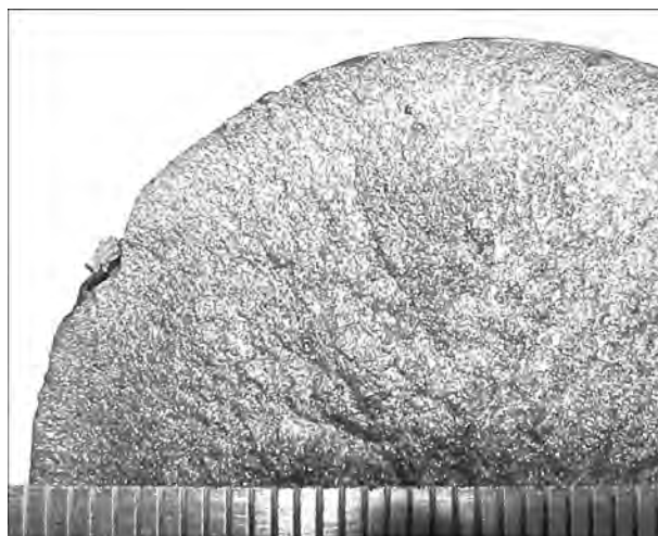
Рис. 2. Излом отливки \gamma -TiAl
