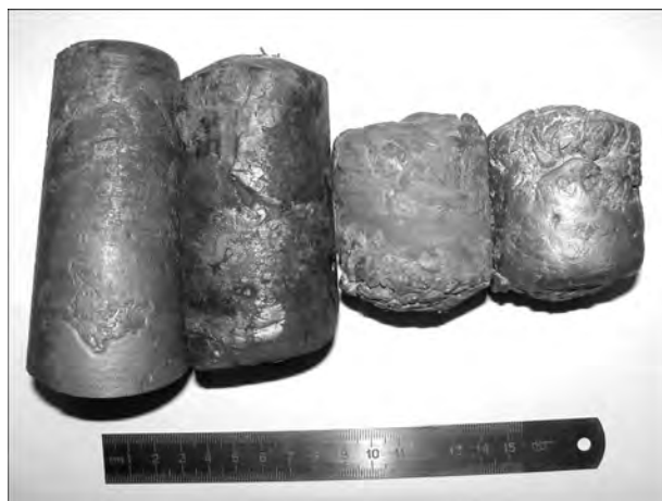
Рис. 1. Отливки, полученные при плазменно-дуговой гарнисажной выплавке \gamma -TiAl
