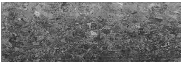
Рис. 9. Макроструктура поковки титанового сплава ВТ6
