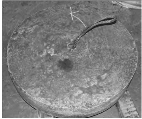
Рис. 7. Поковка диаметром 870x160 мм из титанового сплава ВТ6
