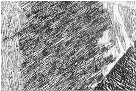
Рис. 3. Микроструктура (X100) слитка титана марки ВТ6
