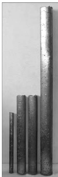
Рис. 1. Спрессованные из титана губчатого расходуемые электроды диаметром 35, 75 и 100 мм, используемые при МЭП
