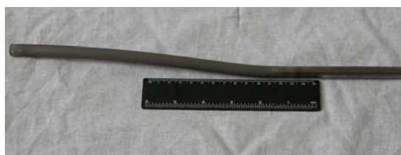
Рис. 3. Экспериментальный образец после длительного прогрева при 1123 К
