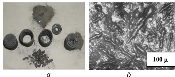
Рис.4. Образец материала из Zr_{mp}+UO_{2(пор)} , T\sim 2300 °С, x200 : а - после оплавления; б - микроструктура образца
