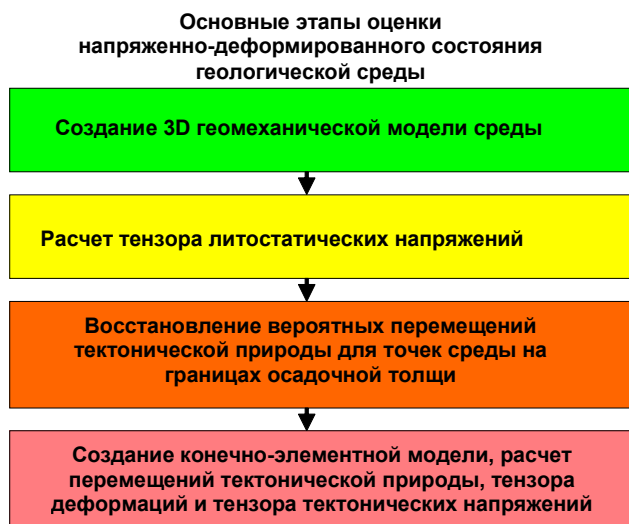
Рис. 1. Блок-схема методики оценки напряженно-деформированного состояния геологической среды на основе структурно-скоростных моделей
