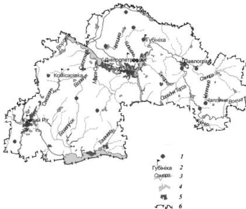
Рис. 1. Схема розташування спостережних свердловин і метеопостів території дослідження: 1 – спостережна свердловина; 2 – метеопост; 3 – річки і водотоки; 4 – водосховища; 5 – населені пункти; 6 – межа адміністративного регіону
