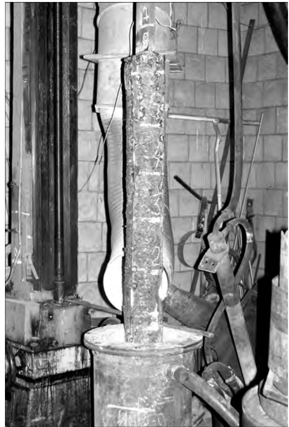
Рис. 3. Электрошлаковый переплав спрессованных электродов
