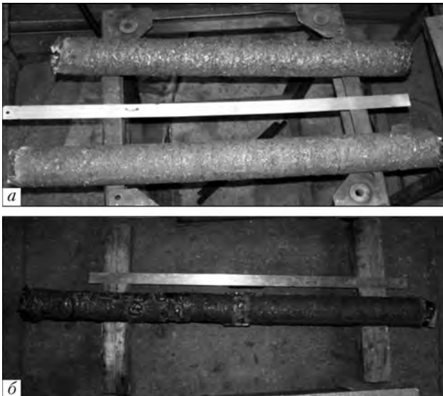
Рис. 1. Получение электродов: a — спрессованного ( L = 1000 мм); б — собранного из двух прессовок ( L = 1880 мм)
