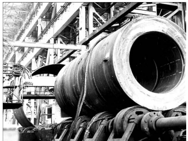
Рис. 11. Электрошлаковая сварка корпуса транспортного контейнера ТК10 из толстостенных обечайки с припаянной нержавеющей футеровкой
