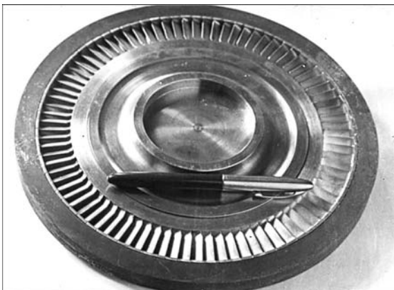
Рис. 2. Диск с лопатками, собранный технологическим кольцом для пайки под давлением
