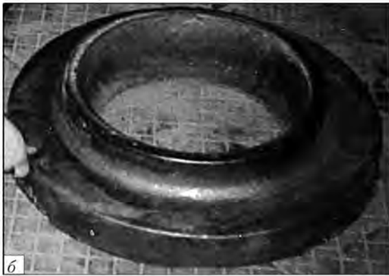
Рис. 5. Конструктивная схема многоместного «вытряхного» кокиля с дозирующим карманом (а) и литая заготовка фланца трубопровода (б)
