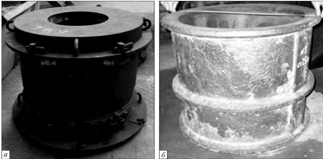
Рис. 3. Секционный одноместный кокиль ЦЭШЛ (а) и корпусная заготовка для газовой турбины (б)
