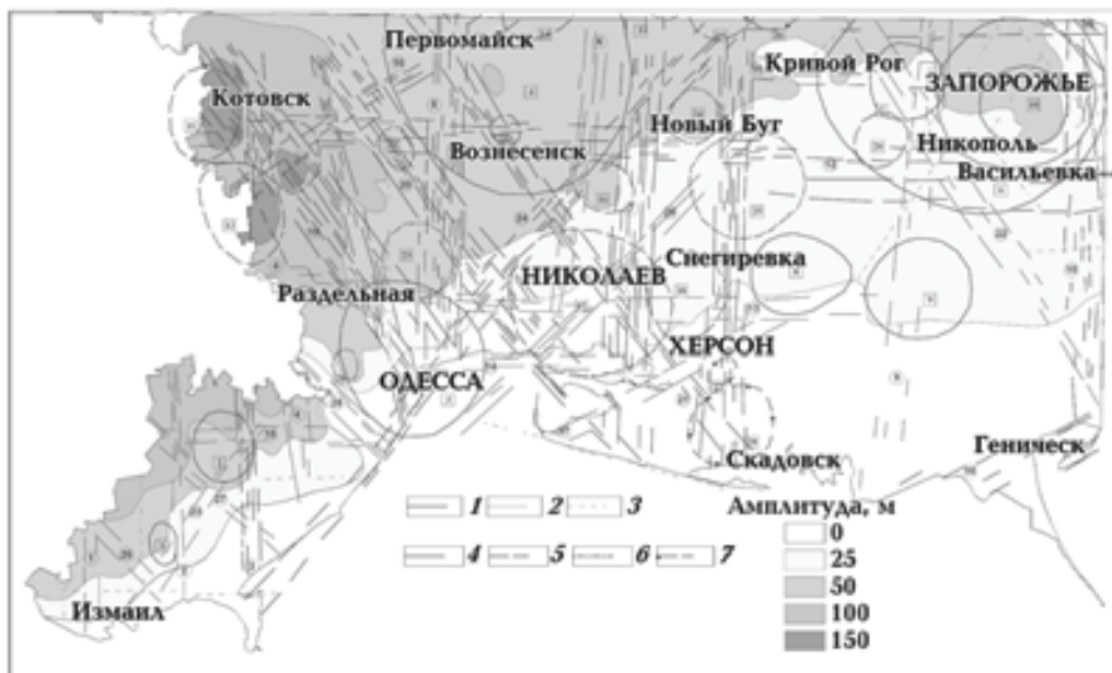
Карта новейшей тектоники западного (Преддобруджского) сегмента Скифской плиты и прилегающих территорий: 1 — линеаментные зоны 1-го порядка и составляющие их элементарные линеаменты; 2 — то же 2-го порядка; 3 — одиночные линеаменты; 4—7 — кольцевые геоструктуры (4 — унаследованные, 5 — неунаследованные, 6 — промежуточные, 7 — безкорневые); цифры в кружках — номера линеаментных зон; цифры в квадратах — номера кольцевых геоструктур.
