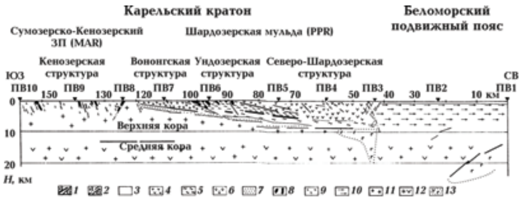
Рис. 5. Сейсмогеологический разрез по профилю III (оз. Кенозеро — р. Нижняя Телза) [Земная..., 1978] с дополнениями авторов: 1 — отражающие границы, соответствующие интенсивным волнам (а) и волнам с малой амплитудой записи (б); 2 — предполагаемые разломы (а — глубинные, определяющие границы крупных тектонических структур, б — внутроструктурные); 3 — фанерозой и неопротерозой (осадки венда и палеозоя). Палеопротерозой: 4 — коматитовые базальты свиты Ветренный Пояс; 5 — терригенные осадки, доломиты, туфосланцы, филлиты, конгломераты виленгской и кожозерской свит; 6 — основные и средние вулканиты киричской свиты; 7 — аркозы, кварциты токшинской свиты. Архей: 8 — интрузивы основных и ультраосновных пород архея и палеопротерозоя; 9 — вулканиты и осадки вожминской серии; 10 — гнейсы беломорской серии; 11 — метаморфические породы и гранитоиды верхней коры; 12 — предположительно переработанные гранитоиды и амфиболиты средней коры; 13 — предполагаемые раскристаллизованные резервуары ветренитовой магмы палеопротерозоя.
