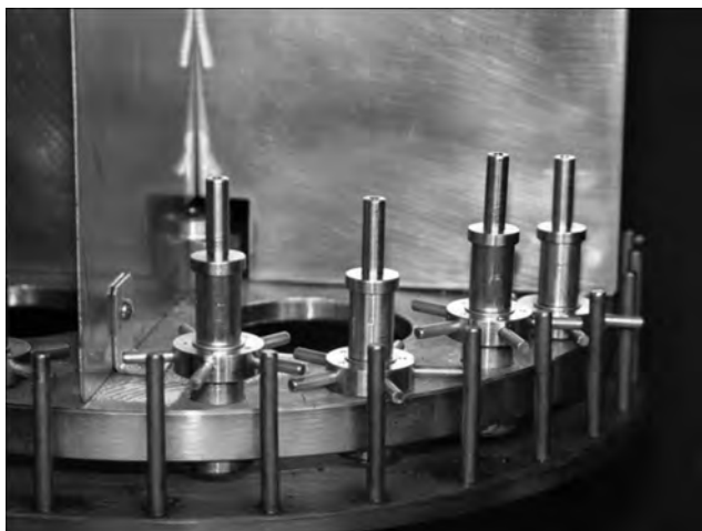
Рис. 3. Четвертая часть стола с подложкодержателями планетарного типа
