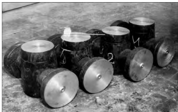
Рис. 5. Внешний вид заготовок корпусов фланцевых задвижек Ду-80 ЭШЛ, подготовленных к ультразвуковому контролю
