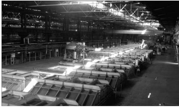
Рис. 7. Обжиговая печь нового поколения (печь № 7)
