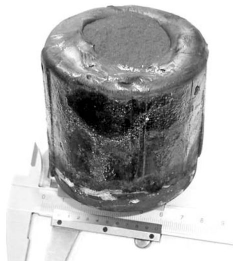
Рис. 9. Внешний вид полых заготовки диаметром 70 мм со стержнем
