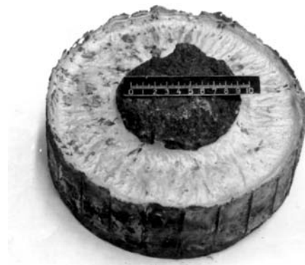
Рис. 12. Отливка-заготовка диаметром 220 мм с графитовым стержнем, полученная на установке ИПСК
