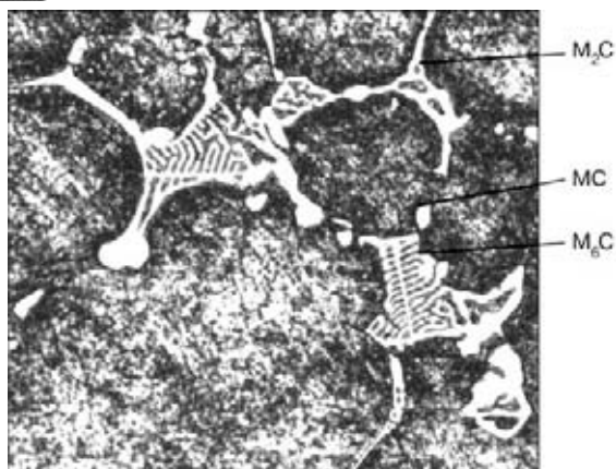
Рис. 2. Морфология эвтектики в литой стали Р6М5 (ЭЛПФЕ), X1200
