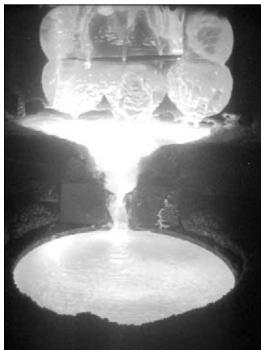
Рис. 1. Выплавка слитка из брикетов губчатого титана
