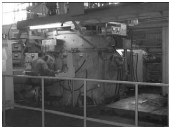
Рис. 2. Внешний вид электронно-лучевой установки УЭ-5812
