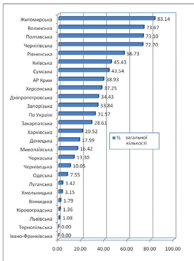
Рис. 2. Ранжування адміністративних областей України за кількістю мостів, які перебувають в умовах загрози від підтоплення
