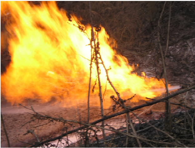
Рис. 8. Поток воды и газы из скв. 37 после перфорации газонасыщенных интервалов на глубинах 450 и 310 м, выделенных по данным зондирования ВЭРЗ
