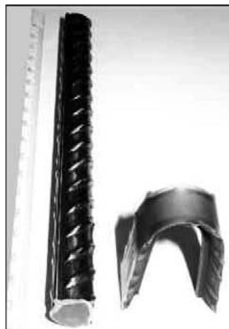
Рис. 4. Внешний вид загнутого образца (продольного макрошлица) биметаллического арматурного профиля диаметром 16 мм
