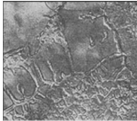
Рис. 2. Микроструктура высокопрочного литейного жаропрочного сплава. Эвтектика  $\gamma + \gamma'$  ( $\times 8000$ )
