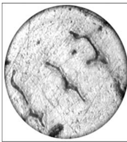
Рис. 12. Образования \delta -феррита в микроструктуре ( \times 200 ) стали С20
