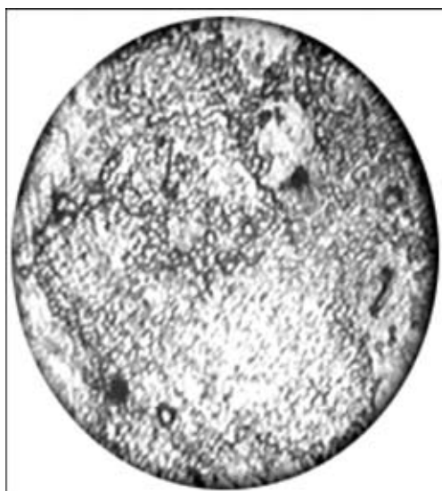
Рис. 11. Микроструктура ( \times 200 ) сплошного слитка из стали С20 после ЭШП
