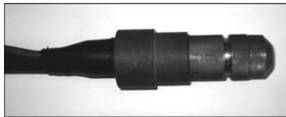
Плазменный резак с воздушным охлаждением установки «Днепр»
