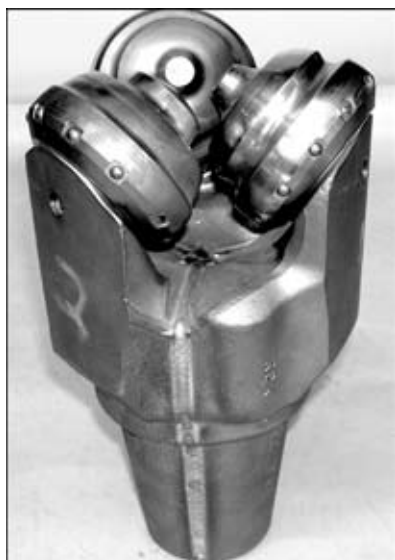
Рис. 3. Внешний вид сваренного долота
