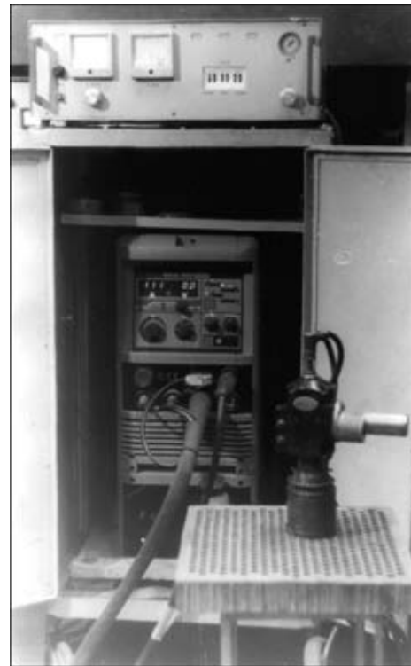
Рис. 3. Сварочный автомат «Агат-1М» для импульсной сварки труб с трубными решетками с принудительным формированием шва
