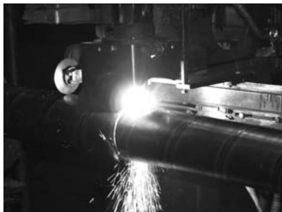
Рис. 5. Отрезной механизм в работе
