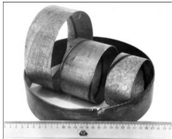
Рис. 7. Спиральношовные трубы, изготовленные из оцинкованной и алюминированной стали
